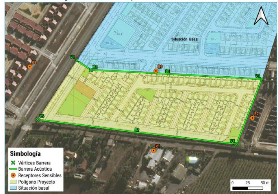
Figura 40: Barreras acústicas para fase de construcción – Lote C.
