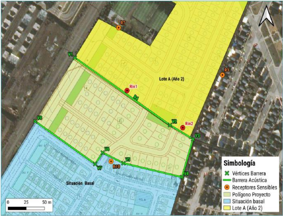
Figura 43: Barreras acústicas para fase de construcción – Lote A (año 3).
