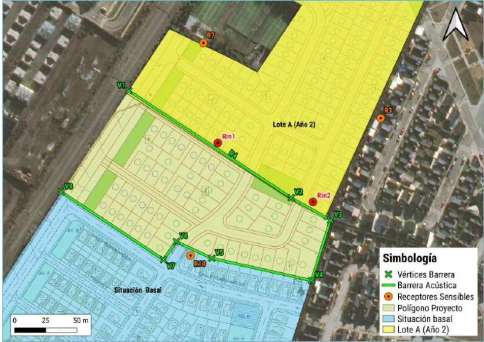
Figura 43: Barreras acústicas para fase de construcción – Lote A (año 3).
