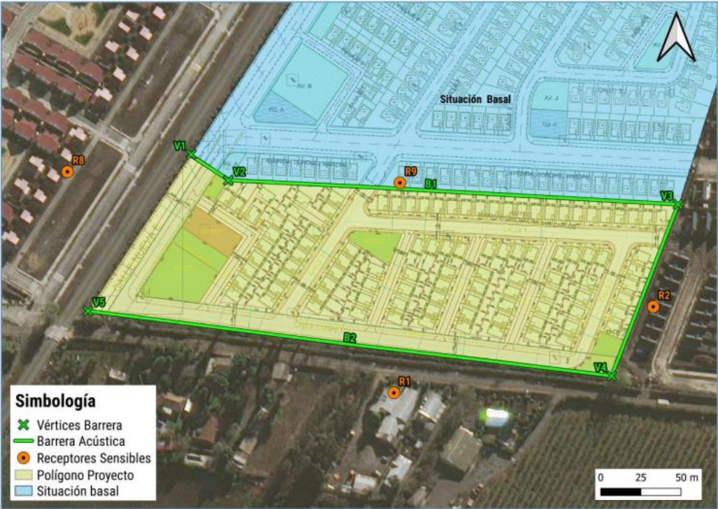
Figura 4: Ubicación de barreras acústicas construcción Lote C.
