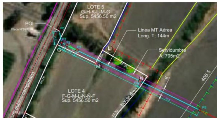
Figura 4.6.1.2.3: Empalme de LTE a poste existente.
