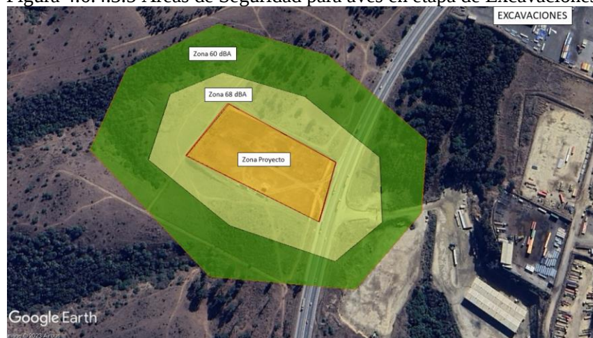
Figura 4.6.4.3.5 Áreas de Seguridad para aves en etapa de Excavaciones.
