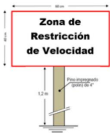
Figura: Señal tipo de restricción de velocidad las cuales deben ser autorizadas previamente por la autoridad competente.
